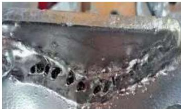
Fig -.6.7: Slag Inclusion
