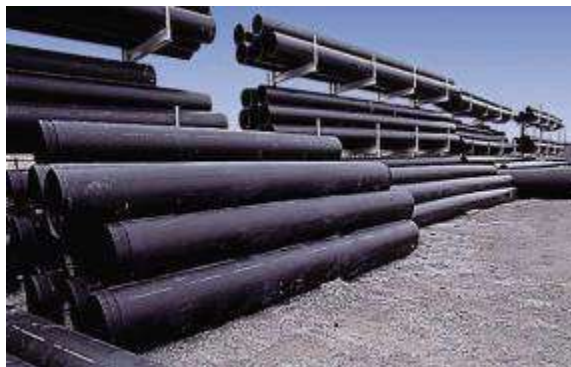
Figure2.1 Storing PE Pipe
