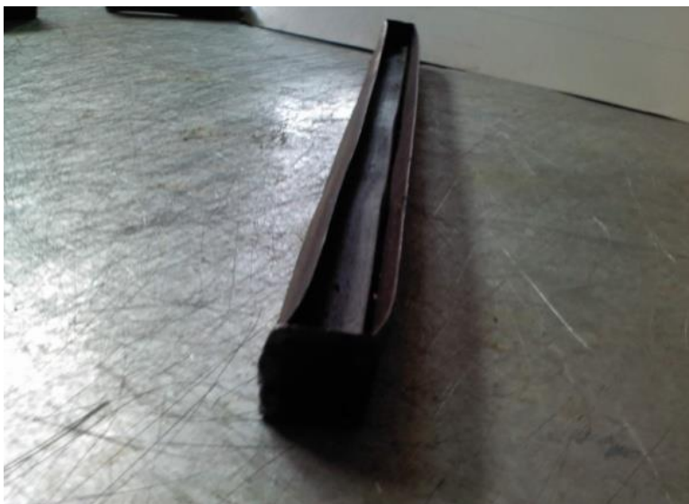
Fig.1.3 Bent Die / Breakage of die:
