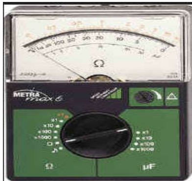
Figure1. 52Ohmmeter
