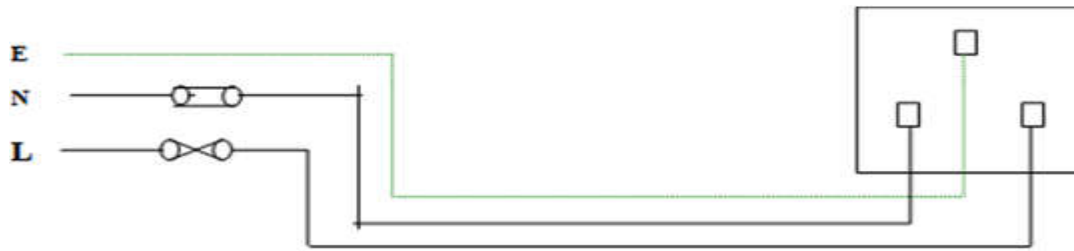
A. Socket outlet –single socket outlet
