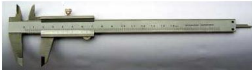
Figure1.21 Vernier Caliper
