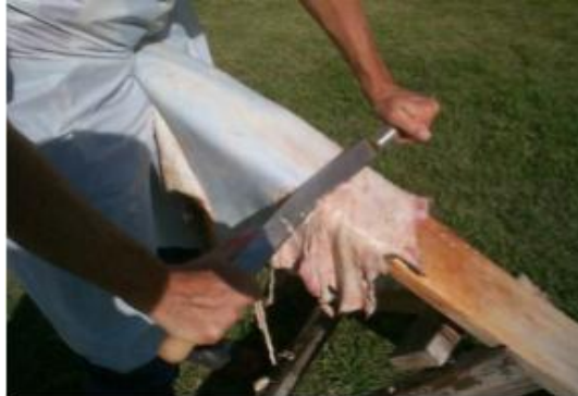
Fig. 1.18. Fleshing using a fleshing knife
